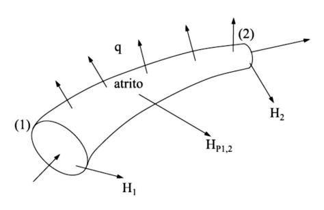
Calor por unidade de peso q > 0 quando fornecido ao fluído q < 0 quando retirado do fluído
