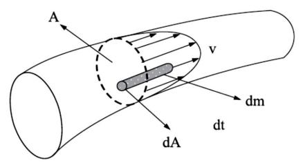
Dessa forma, o termo  $\frac{V^2}{2g}$  terá alteração. Da figura, temos:  $E_c$  calculada no intervalo de tempo dt, através de um dA da seção de área A.
